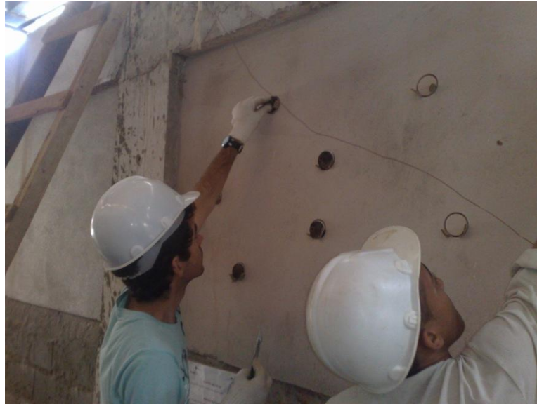
Figura 3.12 – Colagem das pastilhas metálicas.
