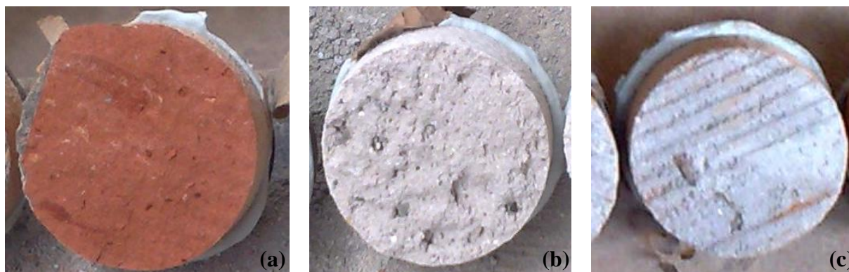
Figura 4.1 – (a) Ruptura no substrato; (b) Ruptura na argamassa; (c) Ruptura na interface argamassa chapisco.
