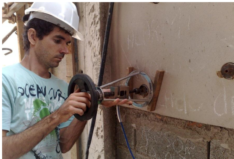
Figura 3.13 – Aplicação da carga através do aparelho de tração acoplado à pastilha metálica
