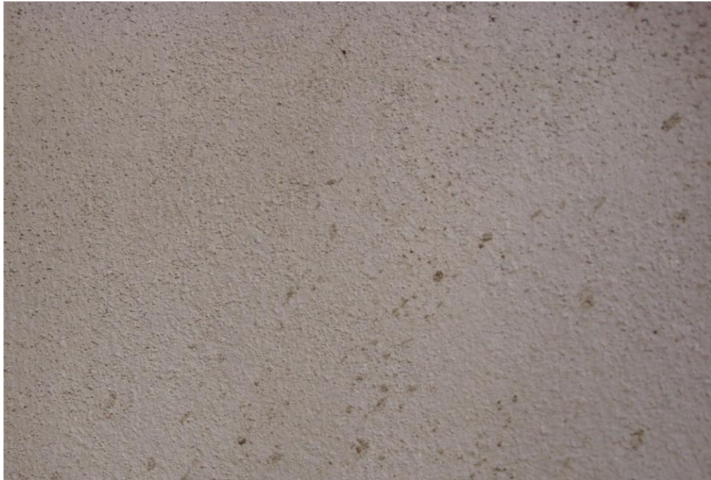
Figura 4.8 – Textura do painel com traço utilizando resíduo de argamassa.
