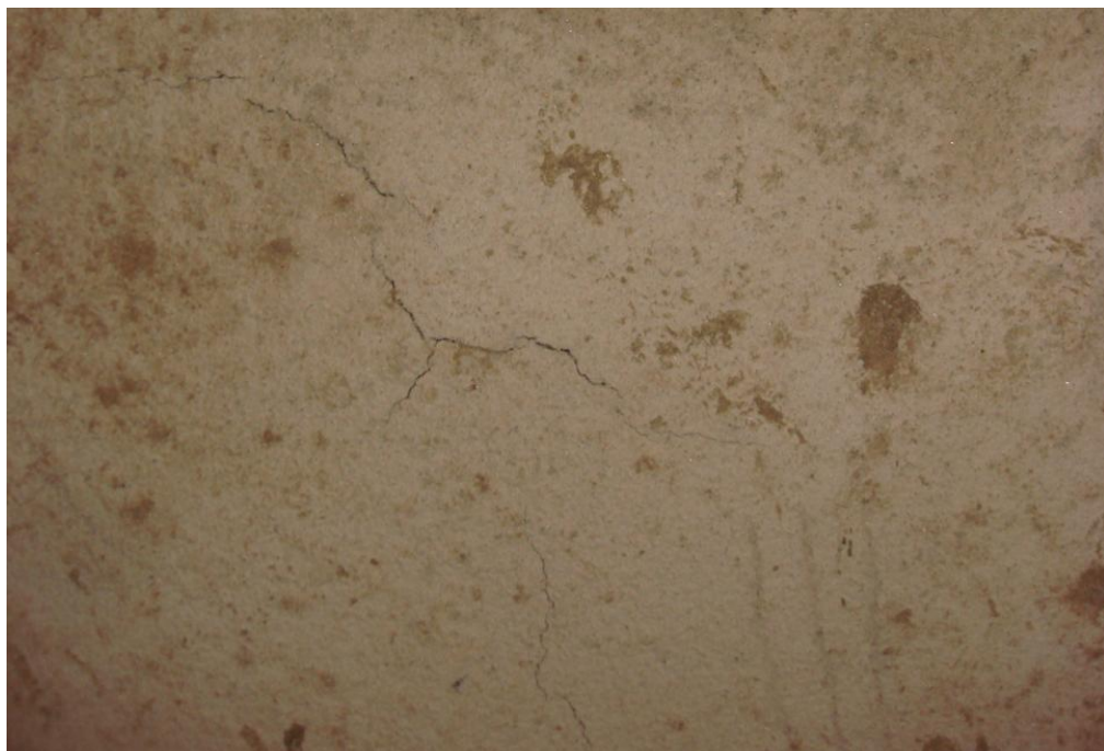
Figura 4.9 – Textura do painel com traço utilizando resíduo de argamassa e retardador de pega MSET-R.
