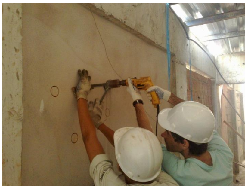
Figura 3.11 – Corte dos corpos de prova com serra copo
