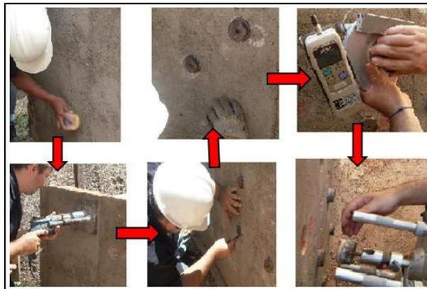
Figura 3 – Procedimento do ensaio de resistência de aderência
