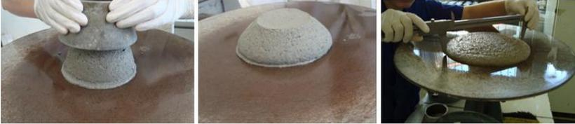
Figura 10: Ensaio de consistência das argamassas
