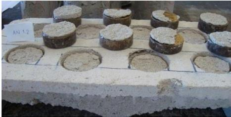
Figura 51: Ruptura dos corpos de prova.
