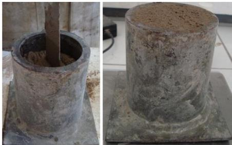
Figura 9: Aparato utilizado no ensaio de massa específica
