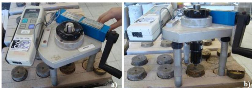
Figura 23: a) Aparato utilizado no ensaio de aderência à tração; b) aparato acoplado na pastilha.
