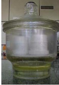
Figura 14: Dessecador utilizado no ensaio de adsorção.
