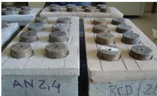
Figura 22: Argamassas com as pastilhas acopladas.
