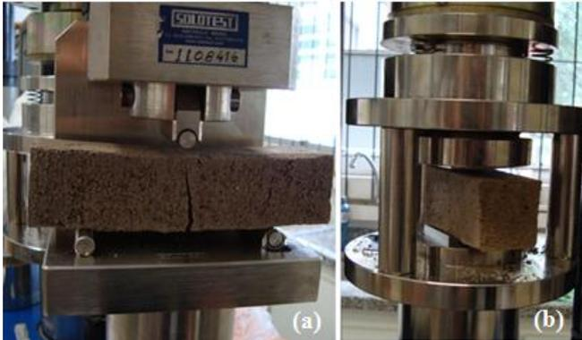
Figura 18: Ensaio de resistência à tração na flexão (a) e de resistência à compressão (b).
