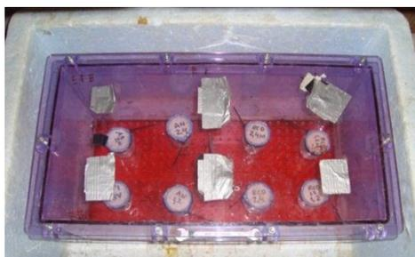
Figura 16: Câmara pronta para o ensaio de permeabilidade ao vapor.
