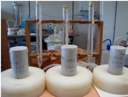
Figura 13: Ensaio de absorção de água por capilaridade.
