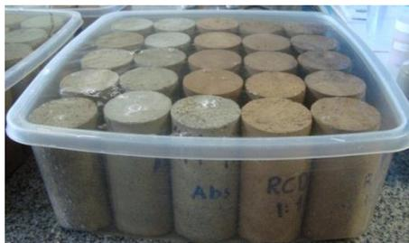
Figura 12: Ensaio de absorção de água por imersão.
