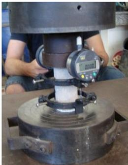
Figura 19: Corpo de prova preparado para o ensaio de módulo de elasticidade.
