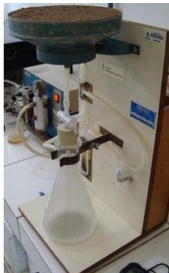
Figura 11: Aparato utilizado no ensaio de retenção de água.
