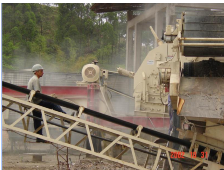
Figura 7 – Emissão de particulado próximo ao britador numa usina de RCD nacional. Extraído de Santos; Pinto (2008).
