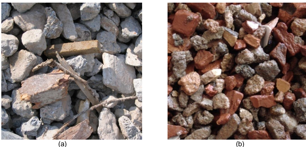
Figura 2 – Agregado de concreto reciclado (a) e agregado de RCD misto (com cerâmica vermelha) (b).
