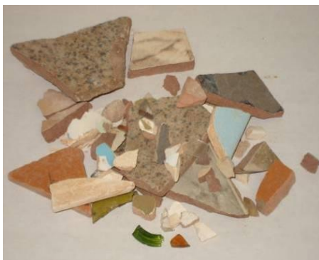
Figura 22 – Materiais identificados no ensaio de catação de acordo com ABNT NBR 15116:2004
