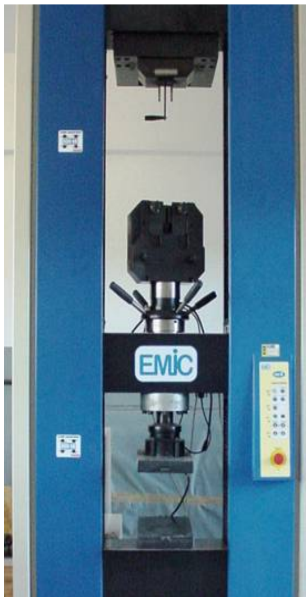
Figura 6.1 – Máquina (modelo DL Emic) utilizada nos ensaios para o rompimento dos corpos-de-prova
