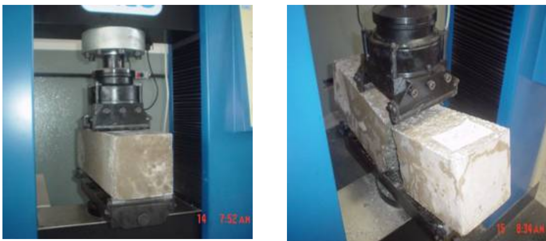
Figura 6.11 – a) corpo-de-prova a ser rompido no ensaio de resistência à tração na flexão b) corpo-de-prova rompido
