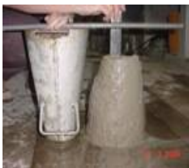
Figura 5.7 a) Concreto C-ART50 Traço rico
