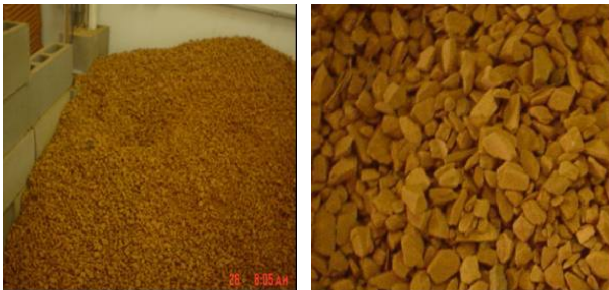
Figura 2.2 – Agregado Graúdo Reciclado de telhas (ART)
