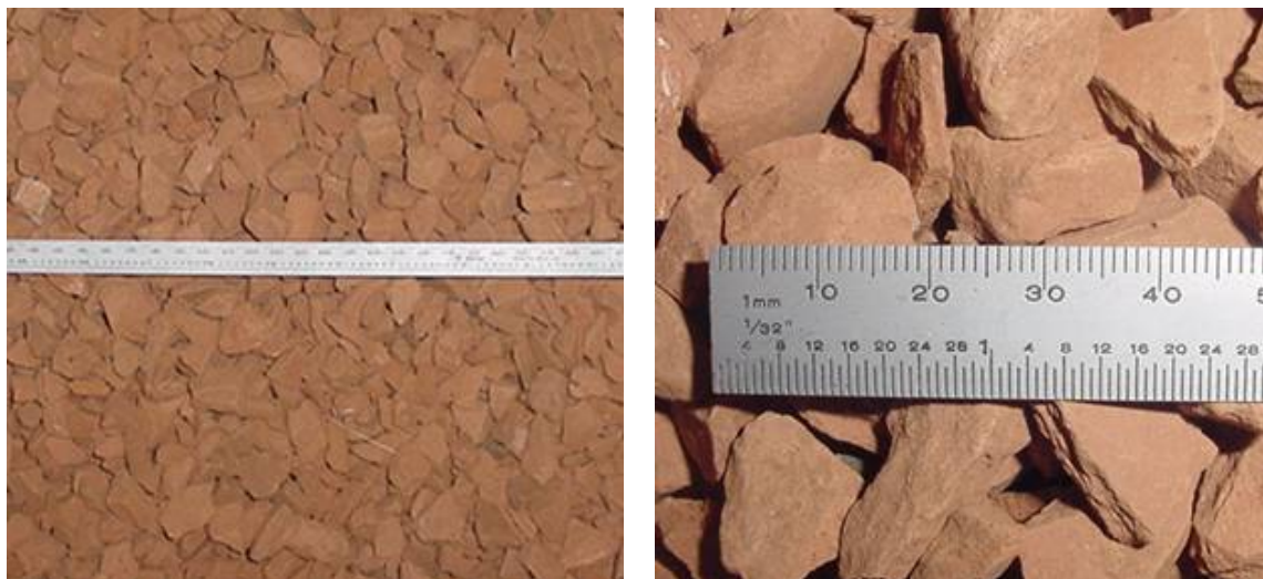
Figura 4.4 – Agregado graúdo reciclado de telha de cerâmica vermelha - ART
