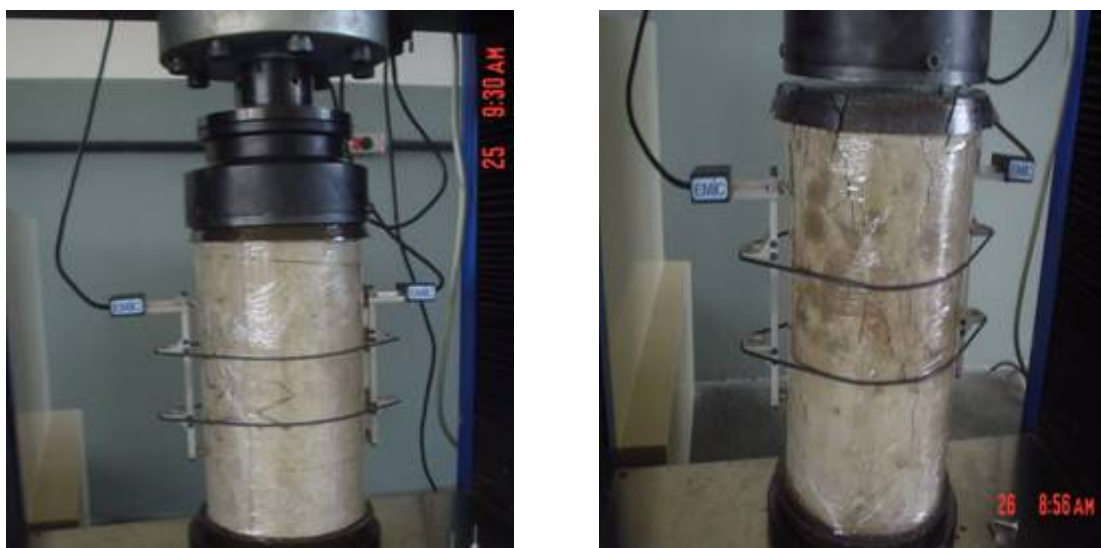
Figura 6.17 – Ensaio do módulo de elasticidade a) corpo-de-prova a ser rompido b) corpo-de-prova rompido
