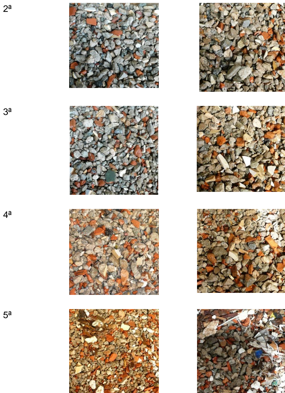
Figura 9 - Resultado visual da separação no jigge por densidade – agregados RCD com predominância de materiais cerâmicos da cidade de São Paulo.
