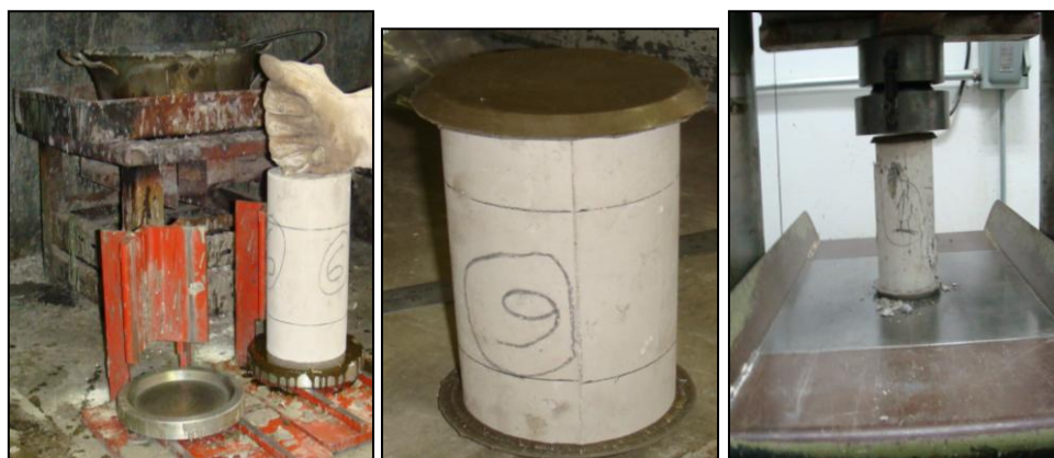
Figura 14 – Capeamento dos corpos-de-prova e ensaio mecânico – resistência à compressão.
