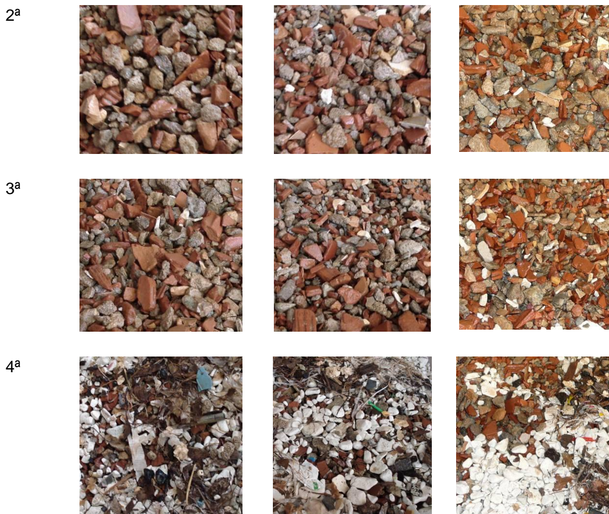
Figura 8 - Resultado visual da separação no jigue por densidade – agregados de RCD com predominância de materiais cerâmicos da cidade de Macaé.
