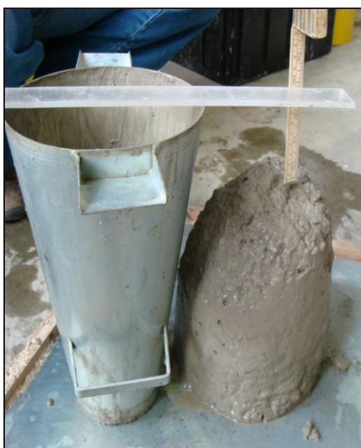
Figura 11 – Medida do abatimento do tronco de cone.
