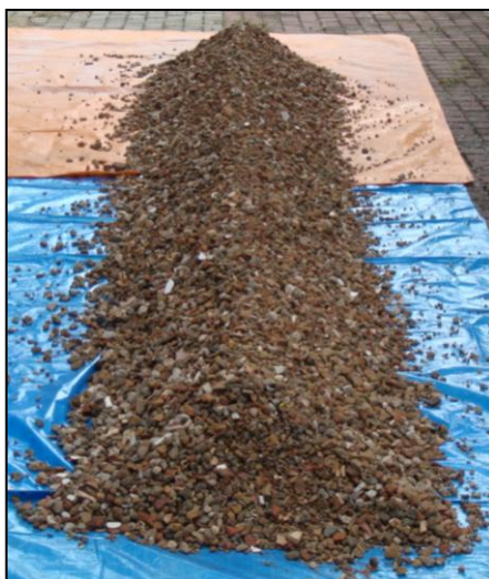
Figura 10 – Etapas da produção da pilha: a) produção da pilha alongada; b) corte de uma das extremidades da pilha alongada; c) pilha de homogeneização finalizada.
