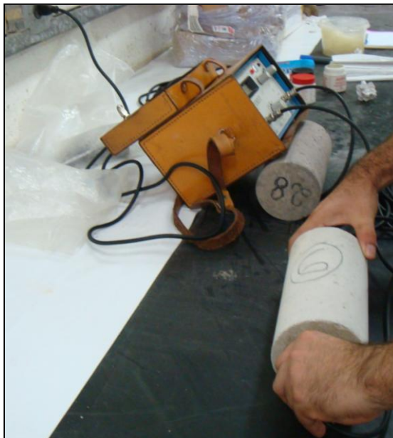
Figura 28 – Ensaio da determinação da velocidade de propagação de ondas ultra-sônicas dos concretos naturais e reciclados.
