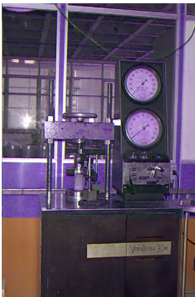
Foto 1 – Detalhe geral do equipamento utilizado - Laboratório do Departamento de Engenharia de Estruturas da Escola de Engenharia de São Carlos – EESC.
