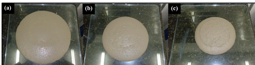
Figura 4: Espalhamento da argamassa ARG-REF: (a) aos 5 min; (b) aos 30 min e (c) aos 60 min.
