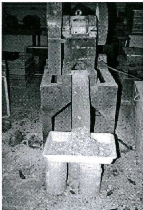
FIGURA 3.8 – Britador do laboratório do DER.
