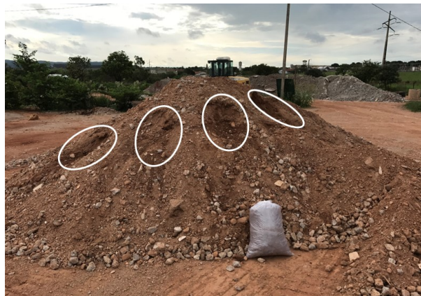
Figura 2. Localização dos pontos de coleta na pilha de RCD-R.
