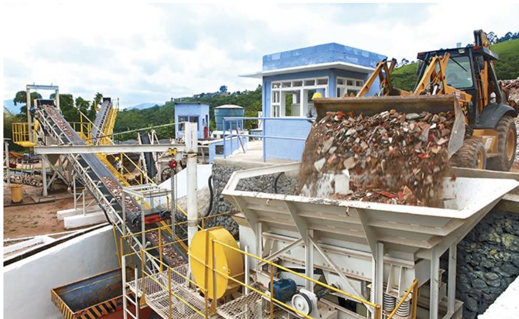
FIGURA 11: Recicladora recebendo resíduos para processamento (foto do autor).
