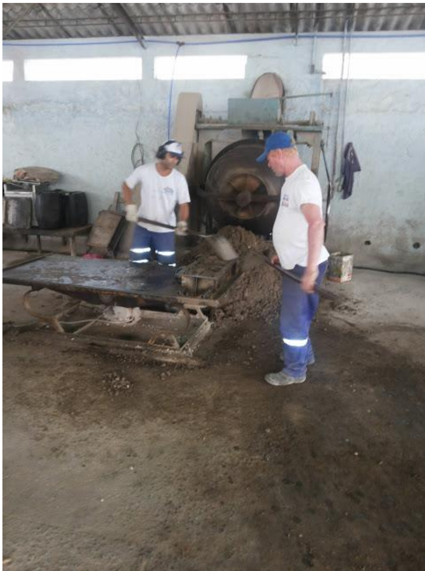
FIGURA 21: Moldagem das formas com massa preparada com agregados reciclados e naturais (foto do autor)
