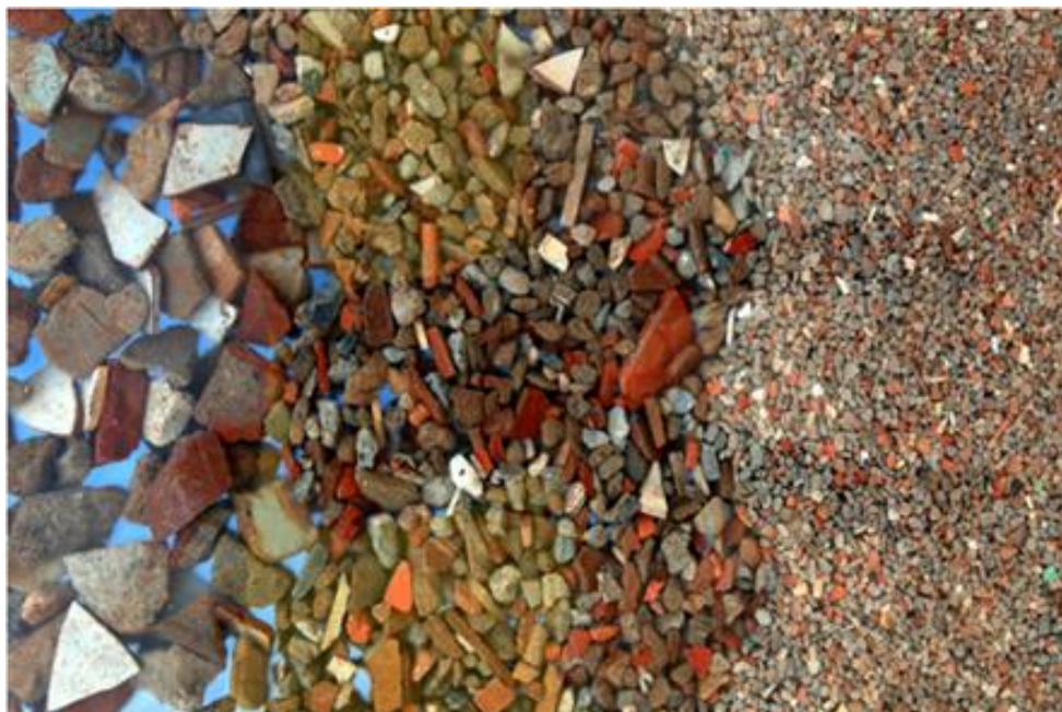
FIGURA 13: Agregados reciclados após a moagem (foto do autor)
