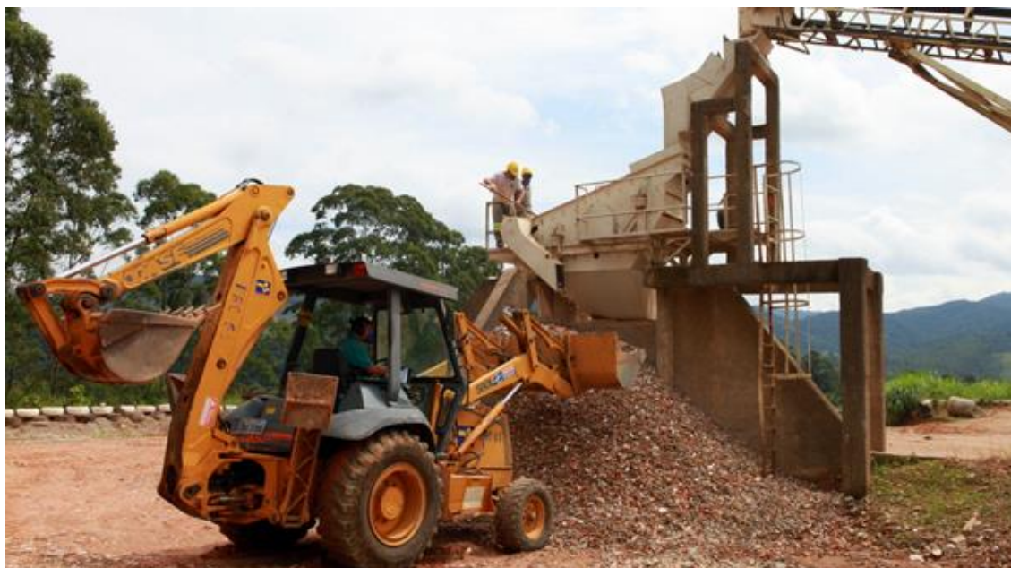
FIGURA 12: Agregados após a moagem sendo retirados pela pá carregadeira (foto do autor)
