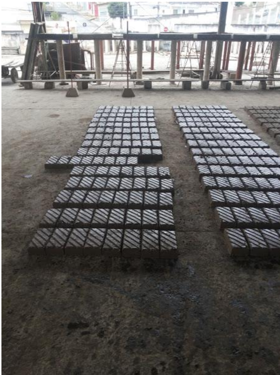
FIGURA 22: Lajotas produzidas com mistura de agregados naturais e reciclados em processo de cura (foto do autor)
