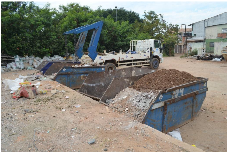
FIGURA 3: Caçambas tipo Brooks para recebimento de RCC (foto do autor)
