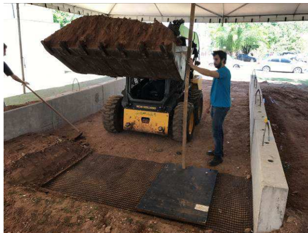
Figura 3.16 – Conferência da altura de queda antes do lançamento do RCD-R.
