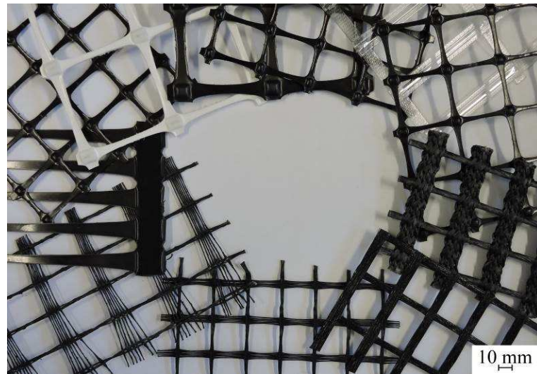
Figura 2.9 – Geogrelhas com diferentes aberturas e fibras.
