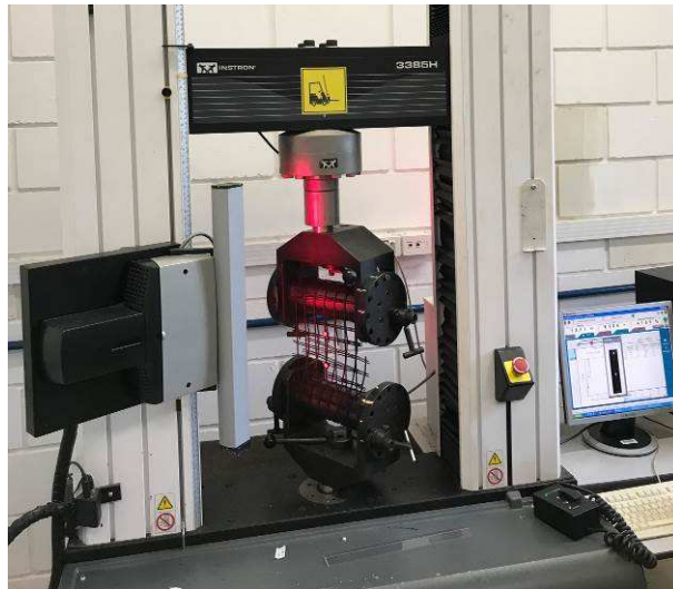
Figura 3.24 – Prensa universal de ensaios com garras de rolete.
