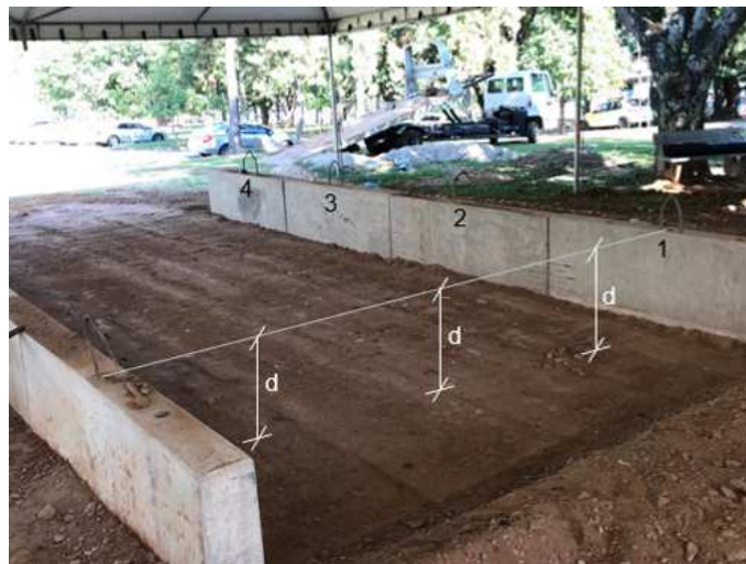
Figura 3.14 – Aferição da espessura da camada da base compactada.
