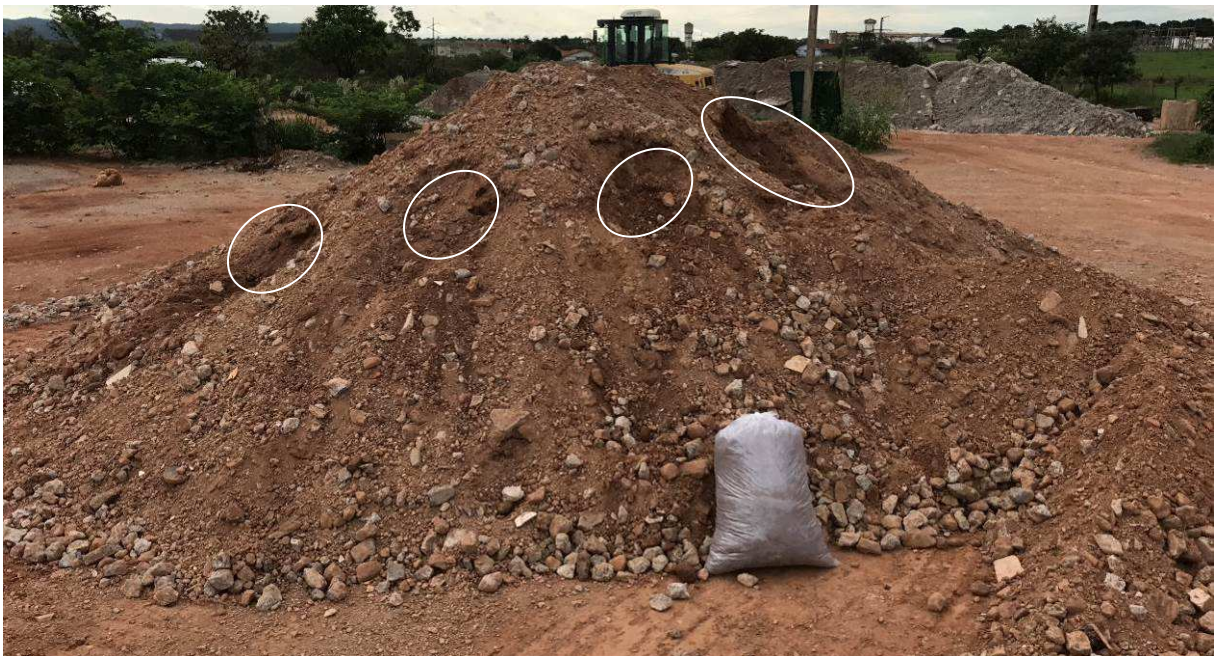
Figura 3.1 – Localização dos pontos de coleta da amostra RCD-R 03.
