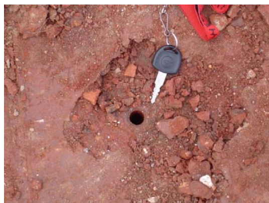
Figura 4.22: Detalhe da superfície após o ensaio DCP sobre camada de reforço de subleito
