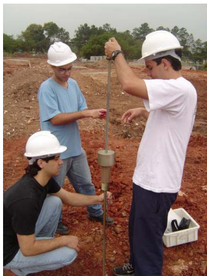
Figura 4.21: Execução do ensaio DCP
