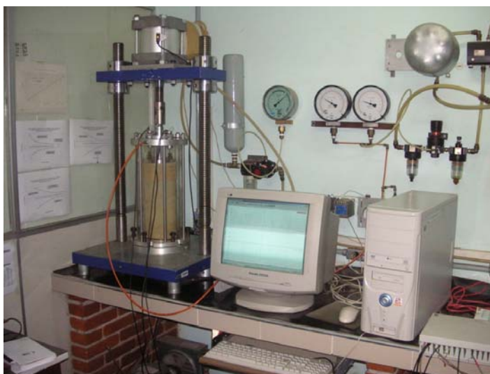
Figura 4.15: Equipamento triaxial de carga repetida do LTP-EPUSP
