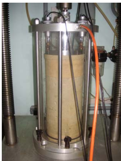
Figura 4.16: Célula triaxial grande utilizada no ensaio com carga repetida
