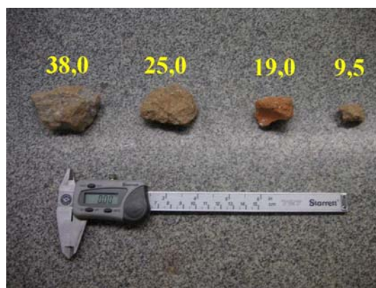
Figura 4.8: Exemplos de partículas pertencentes às frações analisadas
