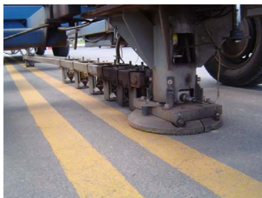
Figura 4.25: Detalhe da aplicação da carga e sensores
