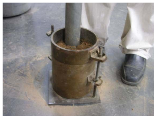
Figura 4.10: Detalhe do cilindro e compactação
