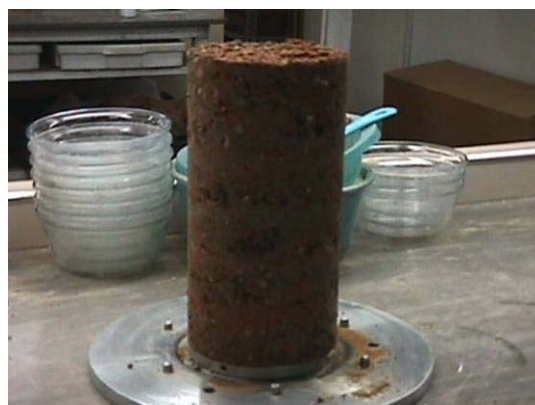
Figura 4.17: Corpo-de-prova de agregado reciclado com 150mm x 300mm
