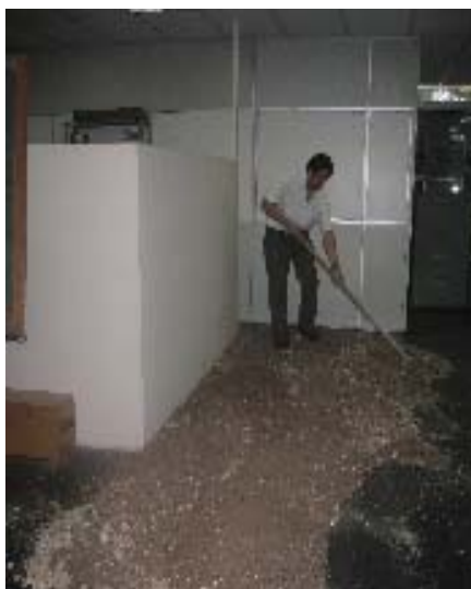
Figura 5.5: Revolvimento do material para homogeneização
