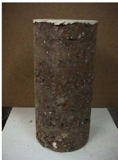
Figura 5.47: Corpo-de-prova de agregado reciclado recoberto por fina camada de gesso em sua extremidade superior
