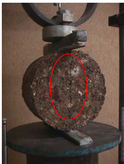
Figura 5.54: Corpo-de-prova rompido no ensaio de Resistência à Tração por Compressão Diametral
