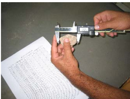
Figura 5.23: Leitura para determinação da forma do agregado reciclado estudado
