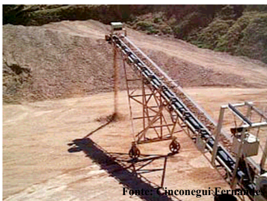
Figura 3.7: Agregado reciclado em esteira transportadora com eletroímã – foto retirada de Fernandes (2004)
