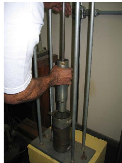
Figura 5.42: Compactação no equipamento MCV adaptado do LTP-EPUSP
