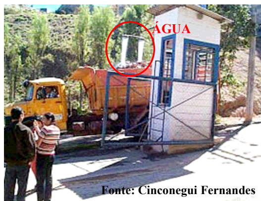
Figura 3.8: Molhagem do resíduo no caminhão, ao chegar na recicladora – foto retirada de Fernandes (2004), com modificações
