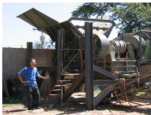
Figura 3.4: Vista de britador primário, em Jundiaí (SP)
