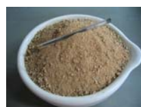
Figura 5.14: Material fino passado na peneira 4,76mm
