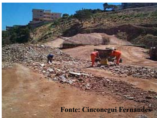
Fonte: Cinconegui Fernandes Figura 3.1: Catação realizada em recicladora de Belo Horizonte (MG) – foto retirada de Fernandes (2004)
