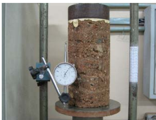
Figura 5.56: Corpo-de-prova no ensaio de Resistência à Compressão Simples
