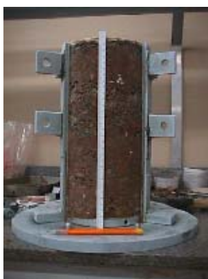
Figura 5.33: Desmoldagem do corpo-de-prova
