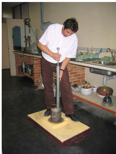
Figura 5.49: Compactação do corpo-de-prova para ensaio de ISC
