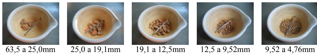
Figura 5.11: Telha e tijolo retidos nas peneiras citadas
