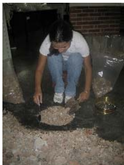
Figura 5.6: Separação do agregado reciclado em porções representativas
