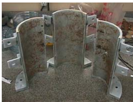
Figura 5.34: Cilindro tripartido desmontado
