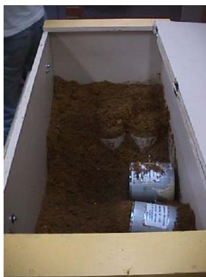
Figura 5.48: Armazenamento dos corpos-de-prova em caixa com serragem umedecida
