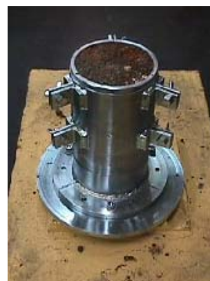
Figura 5.32: Cilindro com o agregado reciclado compactado em seu interior
