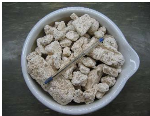
Figura 5.26: Fração de gesso encontrada no agregado reciclado estudado
