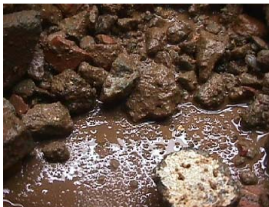
Figura 5.36: Água em excesso na preparação da amostra com umidade de 14%
