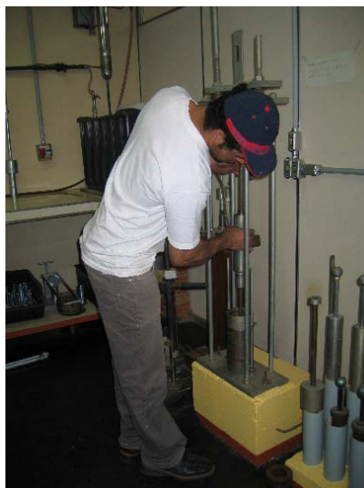
Figura 5.42: Compactação no equipamento MCV adaptado do LTP-EPUSP
