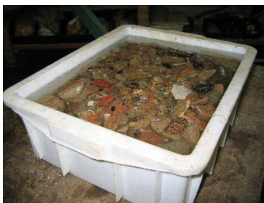
Figura 5.18: Agregado reciclado submetido à absorção de água
