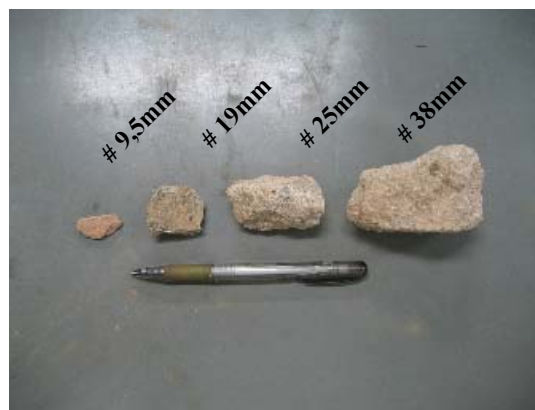
Figura 5.24: Frações granulométricas para determinação da forma do agregado reciclado estudado
