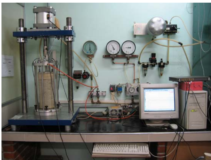
Figura 5.58: Equipamento triaxial de carga repetida e sistema de aquisição de dados para obtenção do Módulo de Resiliência no LTP-EPUSP
