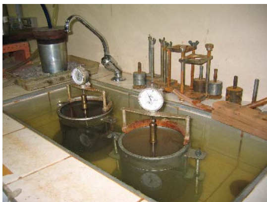
Figura 5.50: Imersão dos corpos-de-prova em água destilada
