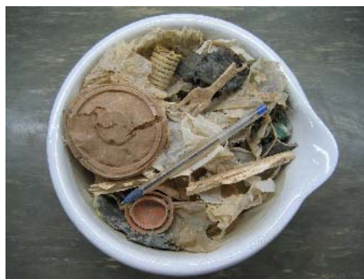
Figura 5.28: Fração de plástico encontrada no agregado reciclado estudado
