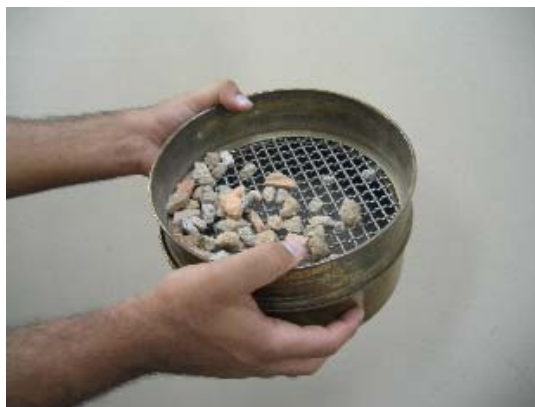
Figura 5.16: Peneiramento a seco do agregado reciclado
