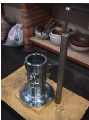
Figura 5.31: Cilindro tripartido e soquete Proctor utilizados
