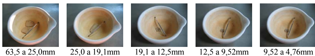
Figura 5.13: Telha de amianto retida nas peneiras citadas
