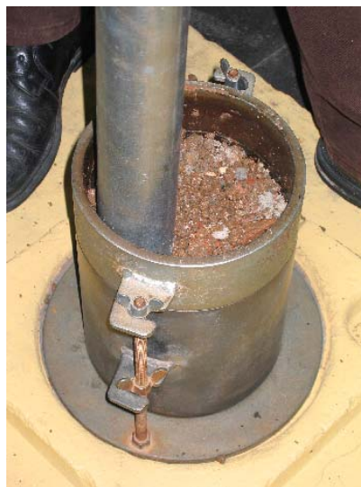
Figura 5.49: Compactação do corpo-de-prova para ensaio de ISC
