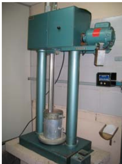
Figura 5.52: Compactador mecânico do LTP-EPUSP
