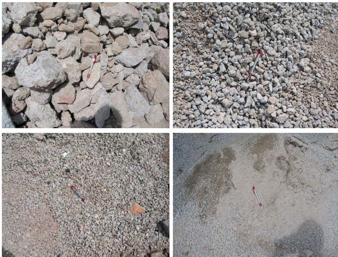
Figura 3.12: Agregados reciclados de concreto classificados granulometricamente
