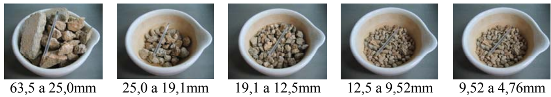
Figura 5.9: Concreto e argamassa retidos nas peneiras citadas
