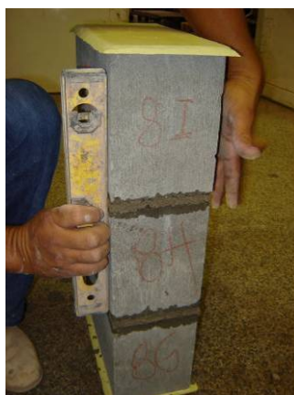
b) nivelamento do prisma
