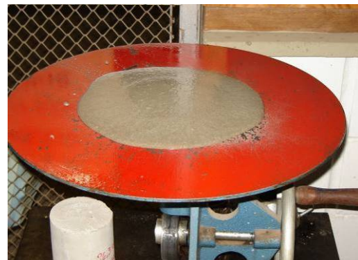
Figura 28 – Ensaio de índice de consistência.
