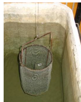
c) determinação da massa imersa na balança hidrostática
