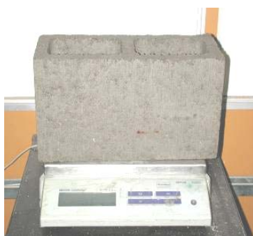
b) Pesagem dos blocos na balança
