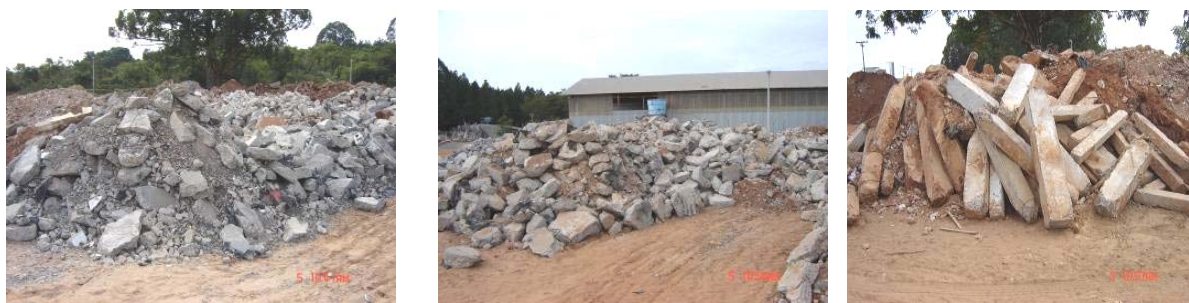
Figura 2.8 – Resíduos de concreto (foto do autor).
