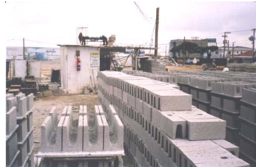
d) blocos canaletas
