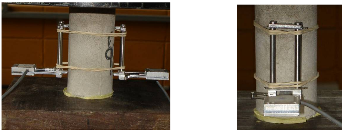
Figura 26 – Instrumentação dos CPs para a realização do ensaio de módulo de deformação.
