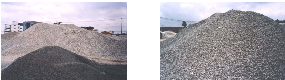
Figura 2.15 – Estoque de agregados reciclados (brita 1 e brita 2) (foto do autor).
