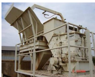
b) alimentador vibratório e britador de martelos
