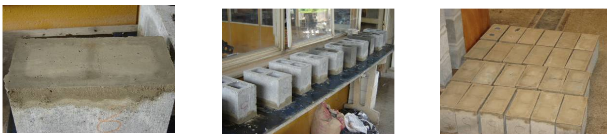
Figura 34 – Blocos capeados com argamassa de cimento e areia.
