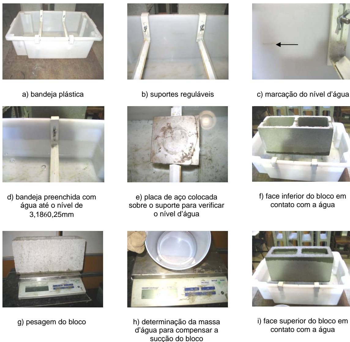
Figura 13 – Equipamentos e alguns detalhes do ensaio da taxa de absorção inicial de água (IRA).
