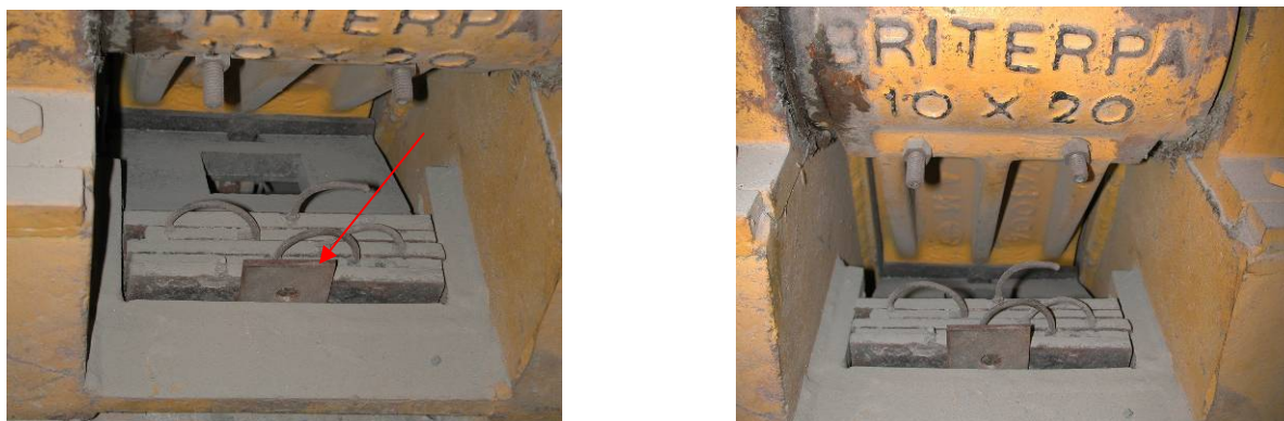
Figura 5.5 – Ajuste realizado na mandíbula do britador para a produção de brita 0.
