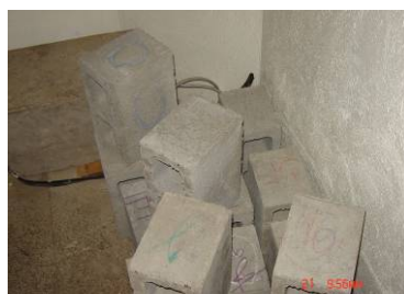
b) colocação das unidades na câmara climatizada (T=25°C e U=50%)
