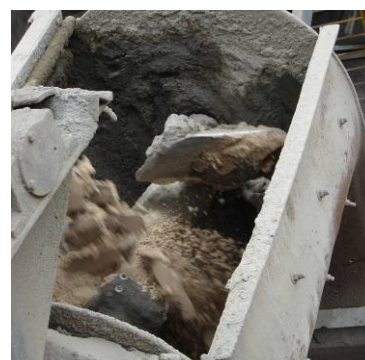
Figura 7.34 – Detalhe do misturador mecânico utilizado na produção dos meios-blocos.
