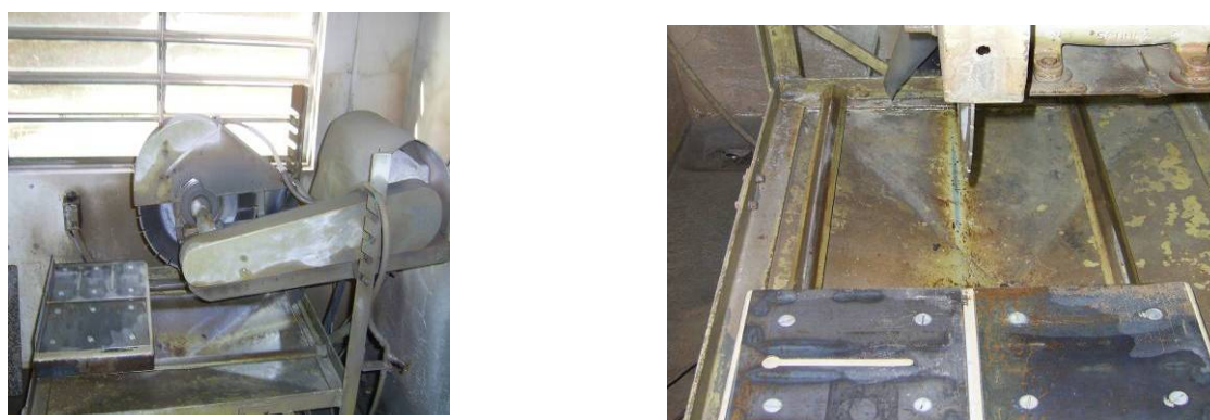
Figura 9.3 – Equipamento utilizado para o corte dos blocos de concreto.
