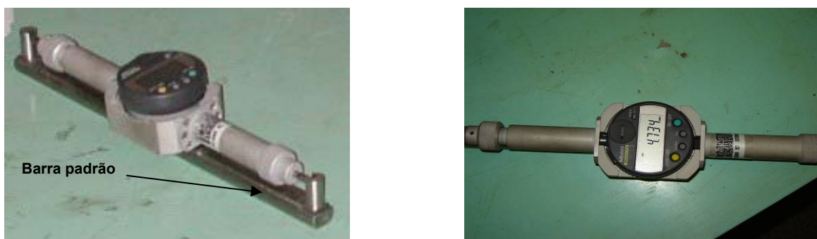
Figura 9.1 – Aparelho digital Mitutoyo e barra padrão de aço invar.
