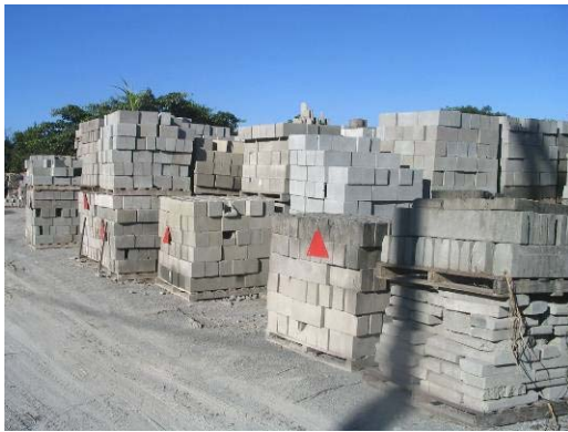
a) blocos de concreto rejeitados pelo controle de qualidade
