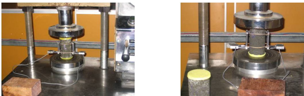
Figura 9 – Ensaio de módulo de deformação na máquina hidráulica Soiltest.
