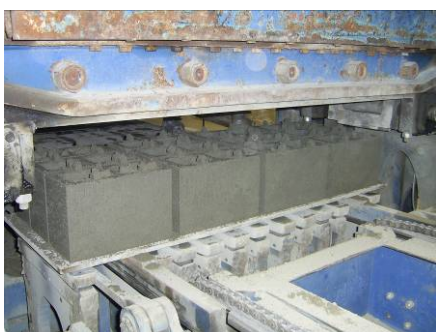
Figura 7.4 – Vibro-prensa utilizada para a produção dos blocos de concreto.
