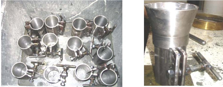
Figura 5 – Fôrmas metálicas para a produção dos CPs.
