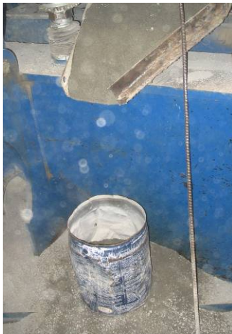
a) resíduos gerados no processo de vibro-prensagem dos blocos
