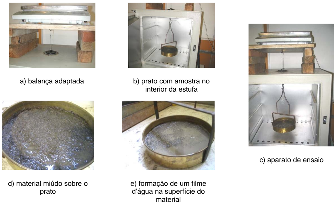
Figura 2 – Detalhe dos procedimentos adotados para secagem dos agregados.
