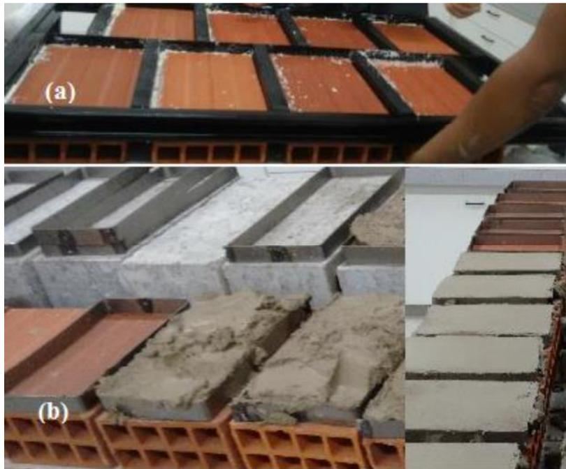
A aplicação das argamassas ocorreu em bancada horizontal, diretamente sobre os blocos (mínimo de seis para cada situação estudada), não sendo confeccionadas paredes devido à possibilidade de manutenção dos corpos de prova, enquanto blocos individuais, em ambiente laboratorial controlado.
