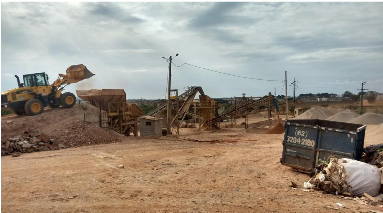
Os agregados reciclados foram produzidos por duas indústrias que possuem o mesmo equipamento de moagem e processo produtivo. O resíduo misto, foi originário de blocos cerâmicos e telhas e restos de concreto de construções, não houve acréscimo de resíduos de demolição para a produção dos agregados. O agregado cimentício foi originado a partir da moagem de restos de concreto caminhões betoneira de empresas de concretagem da região metropolitana de Goiânia-GO.
