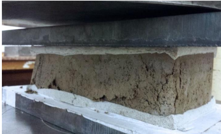
Fig. 4. Ensaio de resistência à compressão: Piso rompido durante o ensaio
