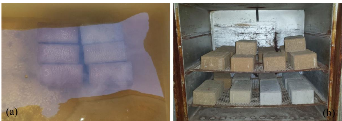
Fig. 5. Determinação da absorção: (a) Pavers submersos por 24 horas; (b) Pavers em estufa até constância de massa
