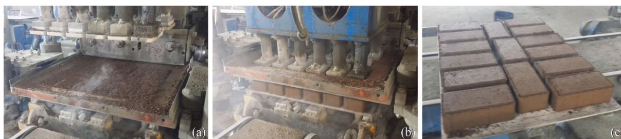
Fig. 3. Sequência da produção dos pavers: (a) carregamento das fôrmas; (b) prensagem dos pavers; (c) lote de pavers pós prensagem.
