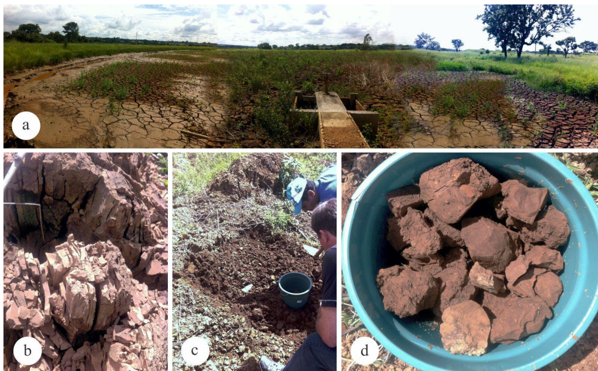
Fig. 2. (a) Lagoa de secagem de RETA (cheia), antes da retirada para disposição em aterro; (b) Detalhe do resíduo; (c) Retirada do resíduo; (d) RETA coletado para análise
