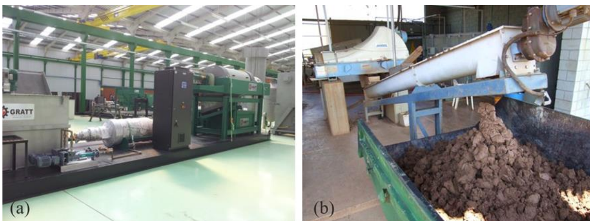
Figura 1.6 – Imagem de prensa desaguadora do RETA (a); RETA após desidratação (b) (GRATT, 2015)
