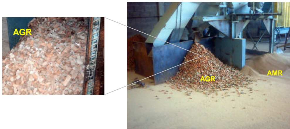
Figura 5.3 – AGR e AMR após britagem do RCD em FURNAS-GO.
