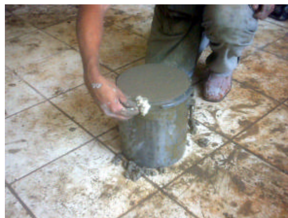
Figura 5.17 – Limpeza do recipiente para aferição de massa específica do concreto fresco.
