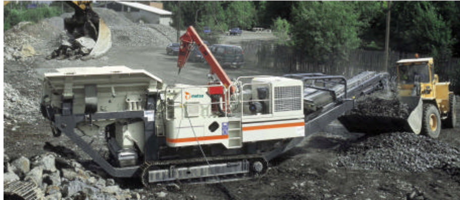
Figura 2.11 – Sistema de planta móvel para britagem (LT 95 Series Mobile Crusher) Fonte: Metso Minerals 12 .
