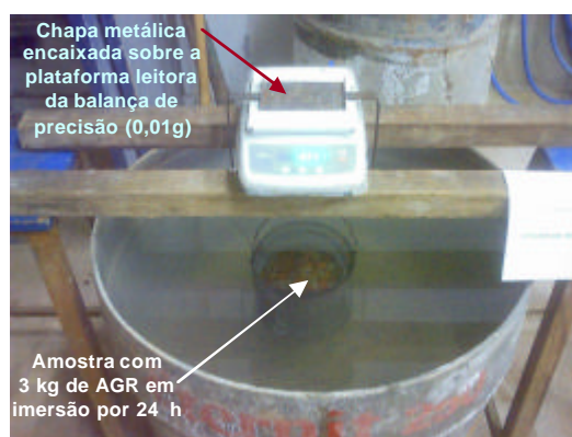
Figura 5.9 – Pesagem hidrostática no ensaio de absorção do AGR.
