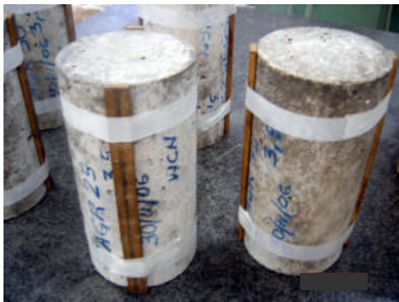
Figura 5.24 – Posicionamento das tiras de madeira nos corpos-de-prova.
