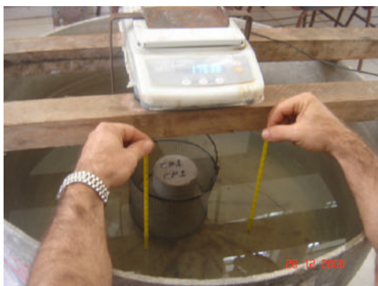
Figura 5.30 – Medida hidrostática de massa do CP e verificação da temperatura da água.
