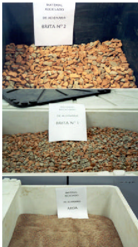
Figura 3.5 – Aspectos dos agregados reciclados: grãos e miúdo (LEVY, 2001).
