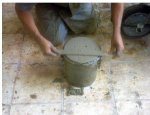
Figura 5.16 – Acabamento superficial do concreto fresco para ensaio de massa específica.
