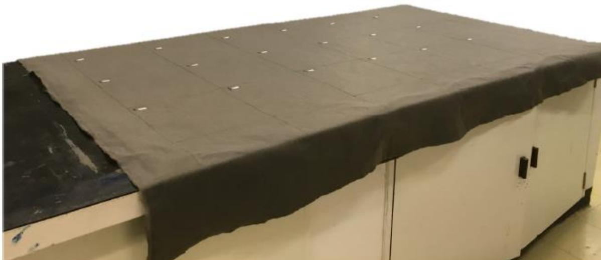
Após os procedimentos realizados por Melo (2018), foram desenhados com canetas permanentes 4 (quatro) círculos com 96 mm de diâmetro em cada espécime de 300 x 300 mm de GTNT. Esse procedimento foi realizado em 8 (oito) espécimes de GTNT<sub>200</sub> e em 8 espécimes de GTNT<sub>300</sub>, de modo a obter 32 (trinta e duas) amostras circulares de 96 mm de cada tipo de GTNT.
