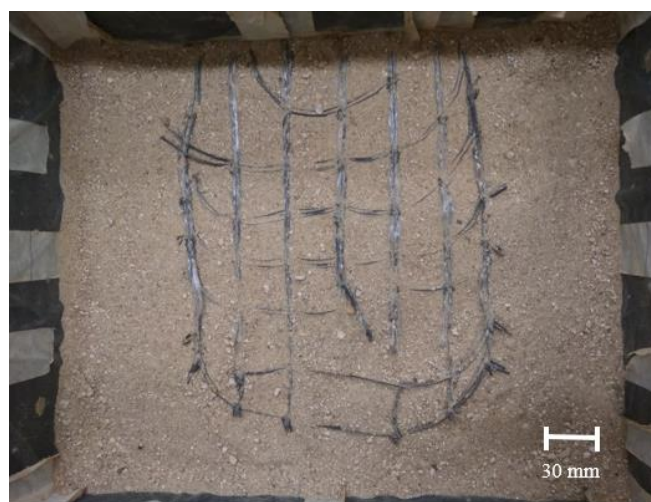
Figura 4.31 – Exumação da geogrelha empregada no ensaio de arrancamento com a AN (sobrecarga de 25 kPa): a) geogrelha envolvida pelo material granular e b) geogrelha após término do ensaio.
