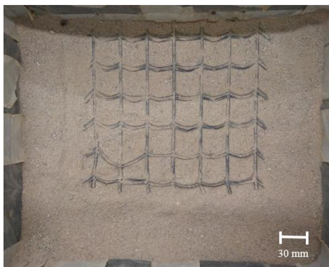
Figura 4.31 – Exumação da geogrelha empregada no ensaio de arrancamento com a AN (sobrecarga de 25 kPa): a) geogrelha envolvida pelo material granular e b) geogrelha após término do ensaio.
