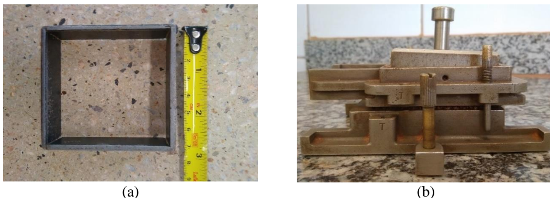
Figura 3.5 – Ensaio de Cisalhamento Direto: a) Vista superior da caixa porta-amostra e b) Conjunto montado.
