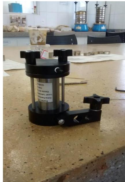
(f) Câmara de ensaio montada.
