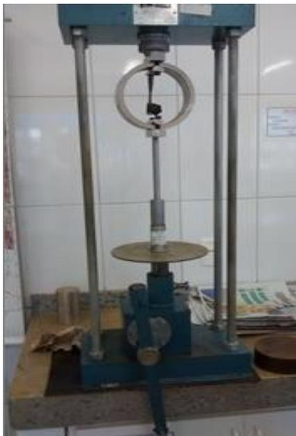
(a) Compactação do corpo de prova
