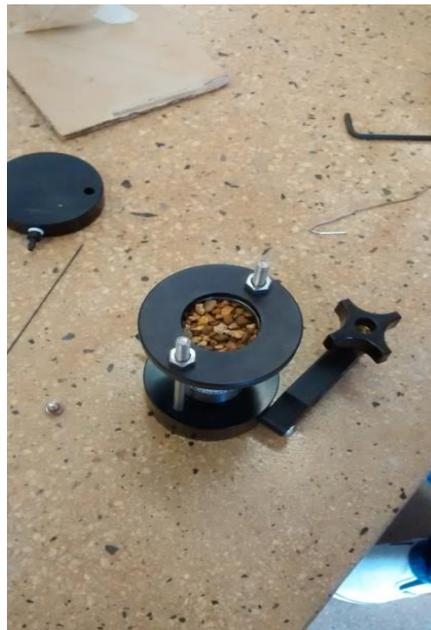
(e) Corpo de prova com a areia grossa e anel de fixação do molde.
