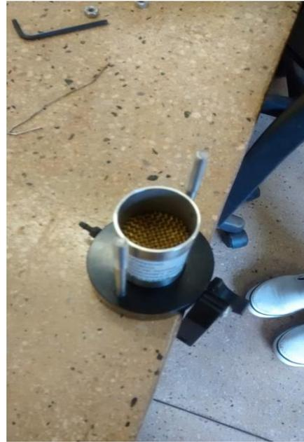
(d) Corpo de prova com as telas de arame.
