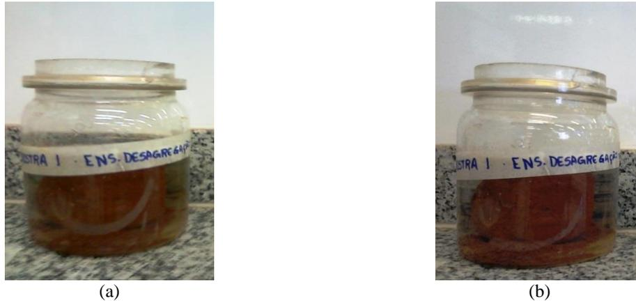
O ensaio de desagregação por imersão total dos CPs da amostra de RCC pode ser visualizado na Figura 4.29. A amostra apresentou desagregação quase total e uma pequena quantidade de espuma foi formada na superfície da água. Ao término do ensaio após 24 h de submersão a amostra teve desagregação total.
