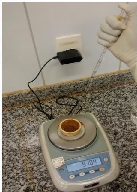
Após o corpo de prova atingir a umidade desejada, três papéis filtro foram colocados em contato com esse, para a determinação da sucção matricial. Então, as amostras devidamente seladas foram guardadas em um recipiente com tampa e colocados dentro de uma caixa de isopor por 14 dias para a ocorrência de equilíbrio de sucção entre o papel filtro e o material ensaiado.
