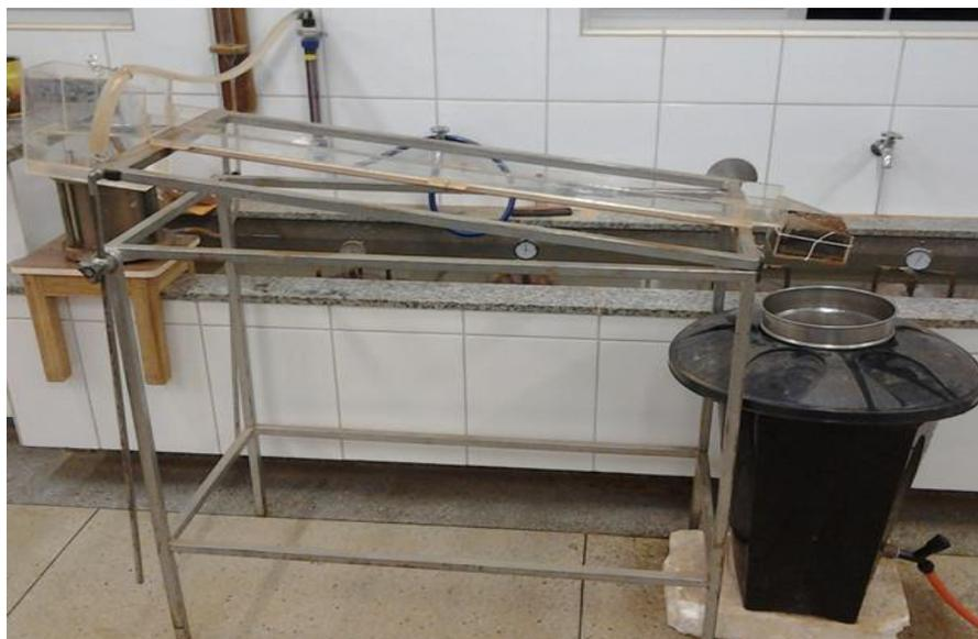
Para a realização deste ensaio, foram feitas a pesagem e medições das dimensões do molde vazio. Posteriormente, o corpo de prova foi moldado e pesado. A seguir, colocou-se o corpo de prova no equipamento de Inderbtizen, conforme apresentado na Figura 3.14. A rampa foi inclinada em  $10^\circ$  e no final da rampa foi colocado uma peneira nº 200 (0,075 mm).
