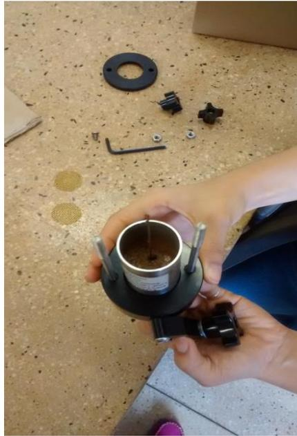
(c) Corpo de prova com o furo da agulha.
