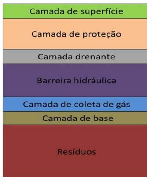
Algumas camadas podem ser combinadas. Por exemplo, tem-se verificado que a camada de superfície pode ser combinada com a camada de proteção. Da mesma forma, a camada de coleta de gás (composta por solo granular) é frequentemente combinada com a camada de base. Vale ressaltar que para a construção dessas camadas, além dos solos naturais, podem ser utilizados também os materiais geossintéticos (KOERNER; DANIEL, 1997).
