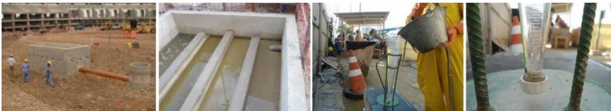
**Figura 27** - Imagens dos decantadores e da análise pelo Cone *Imhoff*.
