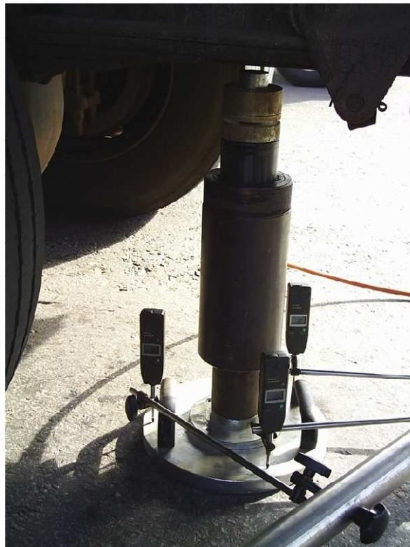
Figura 4.2 – Realização do ensaio de Prova de Carga sobre Placa, em Janeiro/2008, na pista experimental da CEASA.
