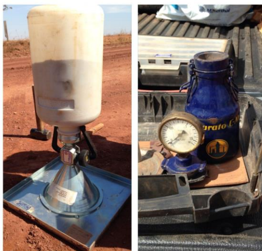
Figura 3.4 - Execução de ensaio de Frasco de Areia e Speedy
