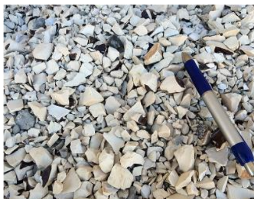
(b) Agregado 25 mm obtido do resíduo
