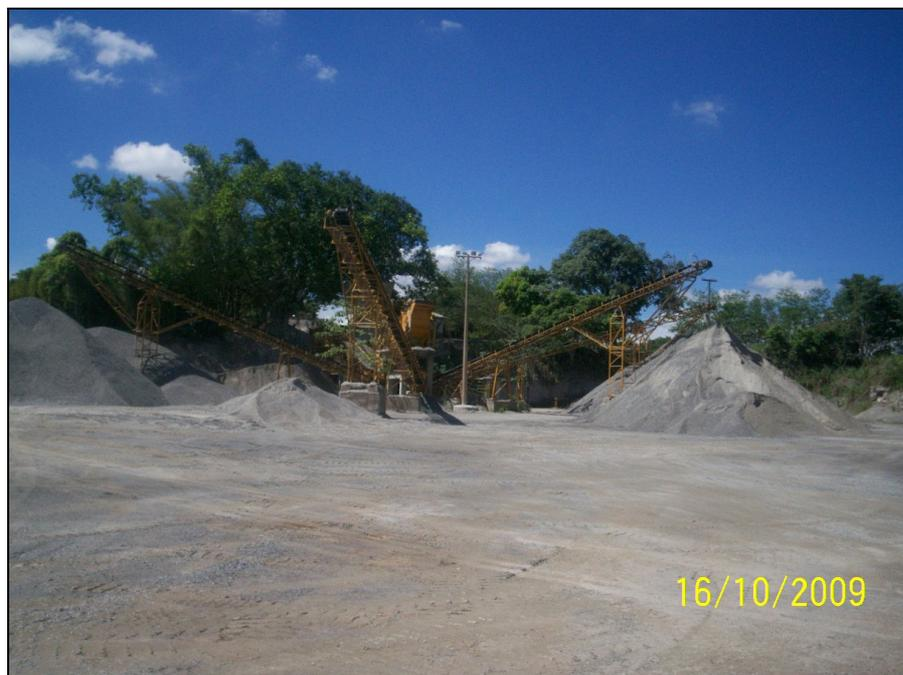
Figura 2.5 – Britador com os diferentes materiais já beneficiados
