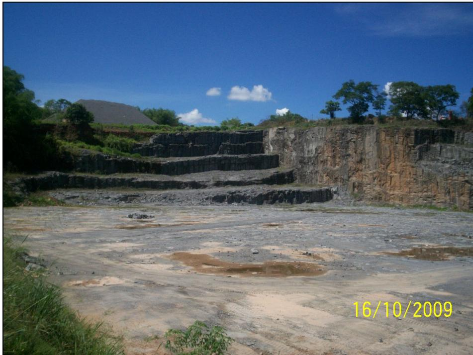
Figura 2.3 – Frente de lavra e bancada para detonação
