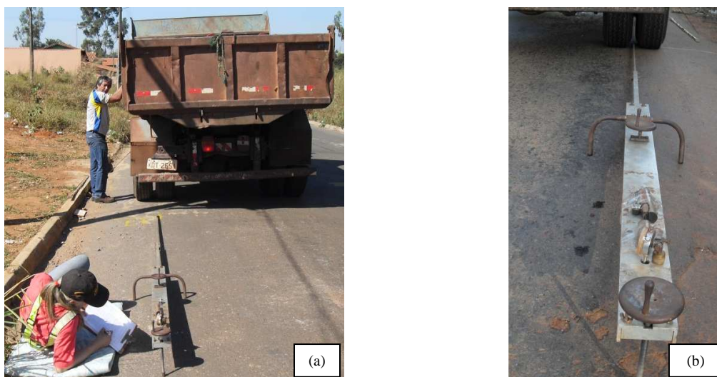
Figura 3.3 – Ensaio de Viga Benkelman (Trecho 2): (a) Ensaio em andamento; (b) Detalhe do equipamento.
