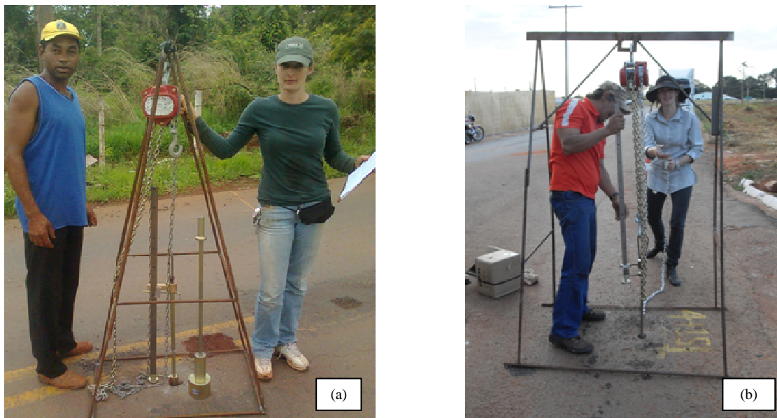
Figura 3.5 – Dynamic Cone Penetrometer (DCP) : (a) Partes do equipamento e suporte para extração; (b) Retirada do equipamento com o uso da talha.
